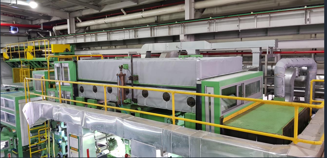
한국슬빔 단열커버 설치 모습
