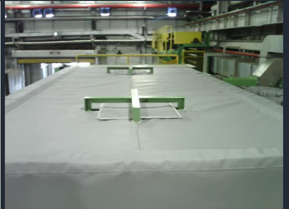
한국슬빔 단열커버 설치 모습
